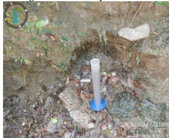
Figura 11.92 – Medição de Vazão
